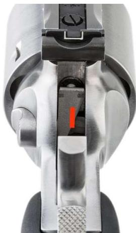
Non solo i revolver *Colt* hanno la *Transfer bar*, ma anche altri concorrenti come i *Ruger* sopra. La staffa/barra è indicata dal trattino rosso, a cane armato, come nella foto, viene sollevata. L'abbattimento del cane provoca l'avanzamento della *Transfer bar*, quest'ultima a causa dell'energia trasmessa colpisce il percussore – dotato di una sua molla di ritorno – posto davanti nel fusto, quel grano posteriore che si intravede nella foto. Ad arma a riposo tale sicura mantiene
