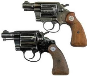
Due revolver uguali in tutto, a parte i materiali. In basso a sinistra il modello Cobra, che ha soltanto la canna e il fusto in alluminio, tamburo in acciaio. In alto a destra il più ultraleggero Aircrewman totalmente in alluminio. Foto: [gunmagwarehouse.com](http://gunmagwarehouse.com)
