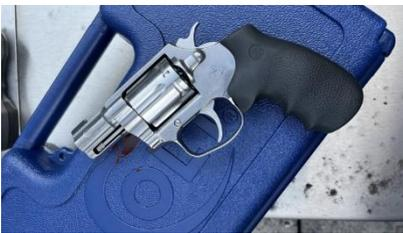
Dal 2017 è disponibile la Terza Versione, con più modifiche: totalmente in acciaio inox per aumentare di robustezza e resistenza, tenendo lontano l'ossidazione e poter camerare le munizioni +P che incrementano le prestazioni balistiche rispetto al .38 Special standard. Mirino sintetico ancora più spianato. La meccanica
