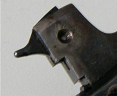
Vista ravvicinata del cane spinato Smith e Wesson. Al centro del cane, un foro con spina passante. Notare le guide di scorrimento – per un’eventuale rimozione del percussore/becco – sulla parte frontale del cane. Foto: Wikipedia.
